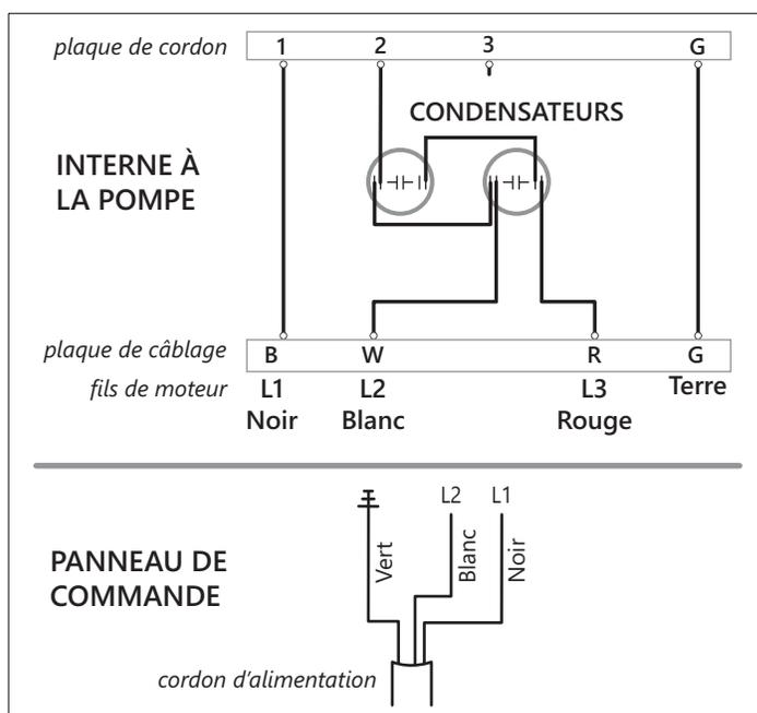
Figure 1. Schéma de câblage pour modèles monophasés, condensateurs internes
