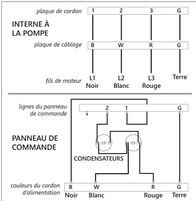
Figure 2. Schéma de câblage pour modèles monophasés, condensateurs externes
