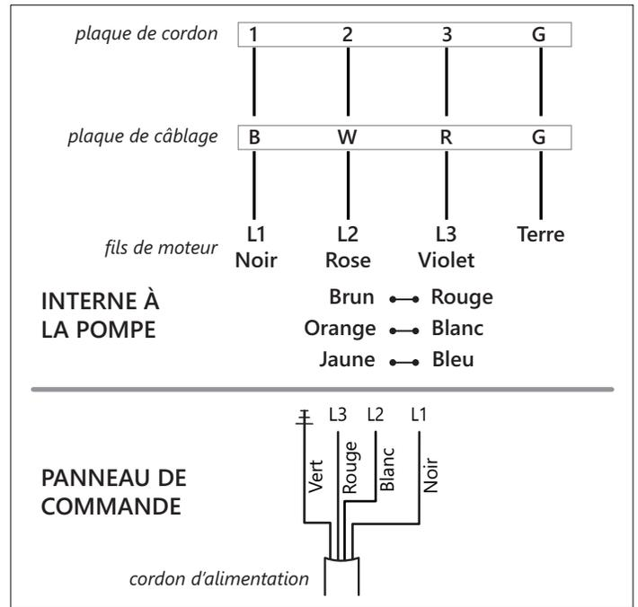
Figure 4. Câblage des raccordements triphasés, 460V
