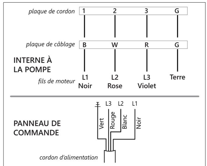
Figure 5. Câblage des raccordements triphasés, 575V
