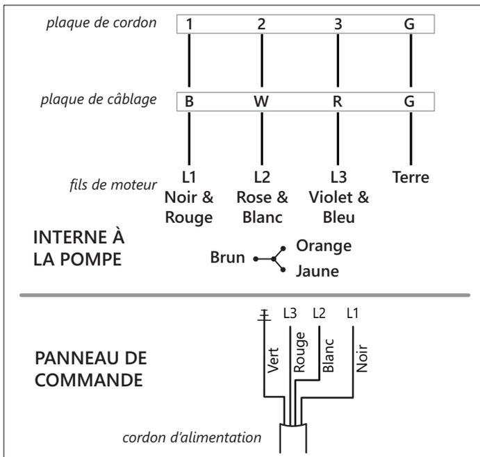
Figure 3. Câblage des raccordements triphasés, 200/230V
